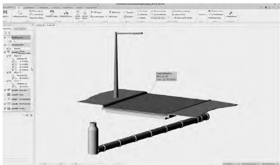
Ausschnitt eines 3D-Abrechnungsmodells einer Erschließungsmaßnahme. ABB.: ISL-KOCHER
